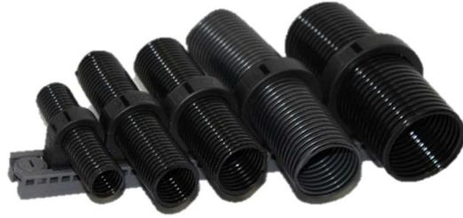
SC-Wellrohrhalter werden aus hochwertigem Polyamid 6 hergestellt. Das Material ist selbstverlöschend, Cadmium-, Phosphor und Halogenfrei. SC-Halter können durch eine Schraube am Boden fixiert werden.
