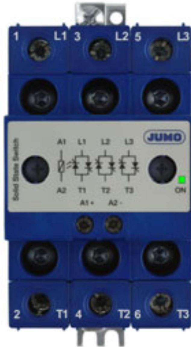
Thyristor-Leistungsschalter als Schaltverstärker für Schraubmontage oder Kühlkörpermontage – mit Kühlkörper. Zum gemeinsamen Anschluss von Lasten bis zu 3x20A über Klemmen. JUMO ist ein eingetragenes Warenzeichen
