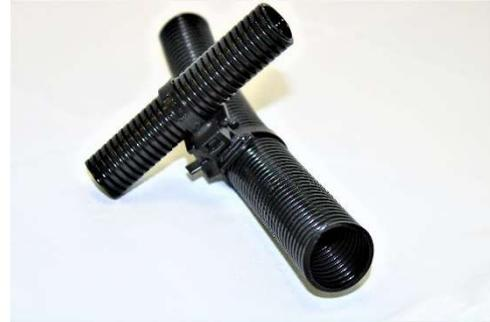
Dickwandige TPE Wellschläuche werden aus einem speziell modifizierten, flamm-geschützten, thermoplastischen, weichen Elastomer hergestellt. Sie zeichnen sich aus durch hohe Abriebbeständigkeit, Reißfestigkeit, Schlagzähigkeit und hohe Flexibilität, auch bei tiefen Temperaturen. Wegen der hohen Wärmestabilität wird diese Rohrqualität besonders für Heizschläuche mit Betriebstemperatur bis 250°C eingesetzt. TPE-Wellschläuche sind sowohl Halogen-, als auch Cadmiumfrei und UV-beständig.
