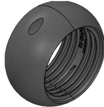
Protektoren gibt es in den Nennweiten 29 bis 90. Sie werden aus hochwertigem Polyamid 6 hergestellt. Das Material ist selbstverlöschend, Cadmium-, Phosphor und Halogenfrei. Ein Protaktor besteht aus Hälften, die mittels zweier mitgelieferter Schrauben verbunden werden. Protektoren dienen als Stoß- und Abriebschutz. Sie sind ebenfalls als Reparaturset oder zur Verbindung zweier Welschläuche geeignet.
