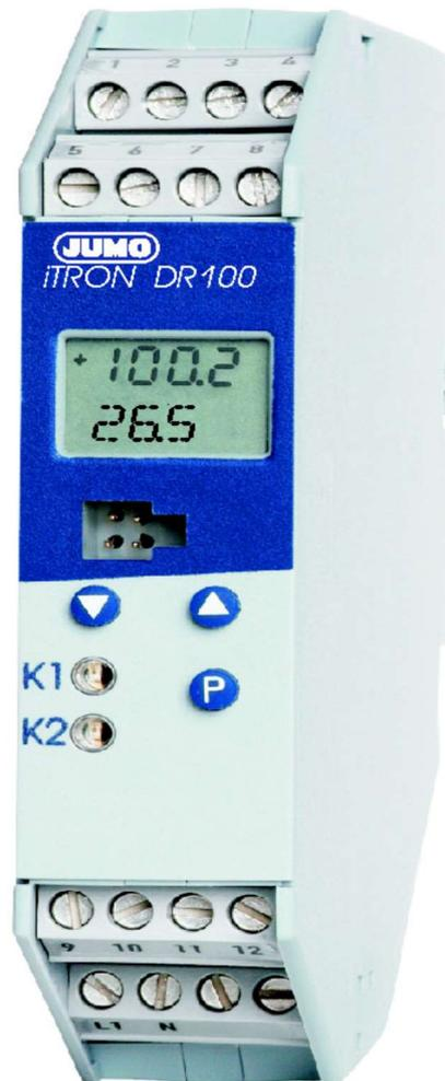
Elektronischer mikroprozessorgesteuerter Temperaturregler für anspruchsvolle Aufgabenstellungen bei der Beheizung von Maschinen, Anlagen und Prozessen für den Schaltschrankeinbau auf 35mm Hutschiene. Ein Verbraucher (Heizung) kann nur in Verbindung mit einem Schaltschütz oder Thyristor- Leistungsschalters angeschlossen werden. Zum gemeinsamen Anschluss von Lastschaltern und Fühler über Klemmen. JUMO ist ein eingetragenes Warenzeichen
