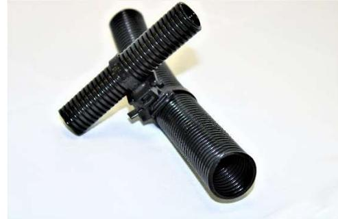
PA12-Wellschläuche werden aus einem modifizierten, harten Polyamid 12 hergestellt. Sie zeichnen sich aus durch hohe Abriebbeständigkeit, Reißfestigkeit, Schlagzähigkeit und Flexibilität, auch bei tiefen Temperaturen. Das Wellrohr ist flexibel und findet im allgemeinen Maschinen-, Fahrzeug- und Sonderfahrzeugbau Anwendung. Wegen der geringen Rückstellkräfte wird der Wellschlauch **auch an Robotern eingesetzt**. Die Wellschläuche sind sowohl Halogen-, als auch Cadmiumfrei und UV-beständig.
