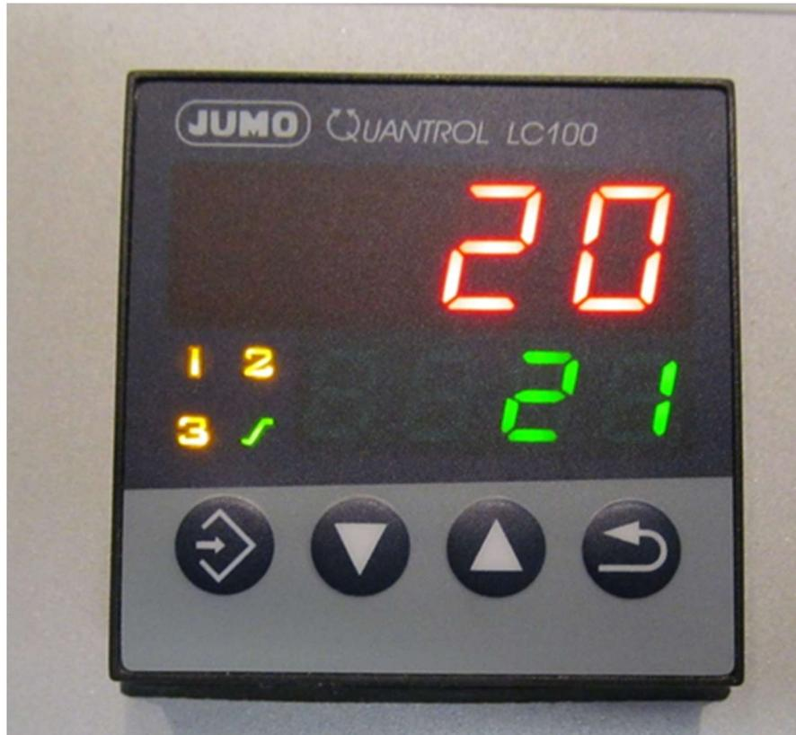
Elektronischer mikroprozessorgesteuerter Temperaturregler für anspruchsvolle Aufgabenstellungen bei der Beheizung von Maschinen, Anlagen und Prozessen für den Frontafeleinbau.
