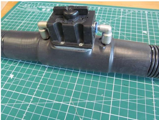
Sprayluft Absperrhahn am Heizschlauch integriert, mit Schrumpfschlauchverstärkung
