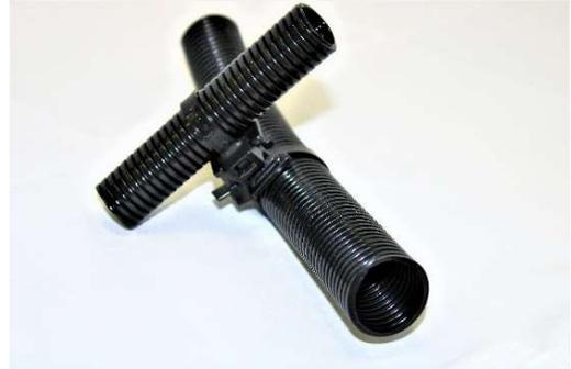
PA6-Wellschläuche werden aus einem modifizierten, harten Polyamid 6 hergestellt. Sie zeichnen sich aus durch hohe Abriebbeständigkeit, Reißfestigkeit, Schlagzähigkeit und Flexibilität, auch bei tiefen Temperaturen. Der Wellschlauch ist flexibel und findet im allgemeinen Maschinen- und Fahrzeugbau Anwendung. Die Wellschläuche sind sowohl Halogen-, als auch Cadmiumfrei und sehr gut UV-beständig.
