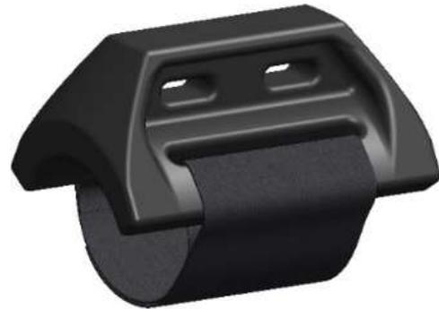
Der Befestigungsbügel aus EPDM ist dafür konstruiert, das Gewicht von Heizschläuchen abzufangen und eignet sich zur Aufnahme von Heizschläuchen mit einem Außendurchmesser von 30 bis 60 mm. Der Befestigungsbügel kann mit Hilfe von Kabelbindern (wiederverschließbar) befestigt werden. Der Heizschlauch wird im Befestigungsbügel durch einen robusten Klettverschluss fixiert. Auf diese Weise kann der Heizschlauch schnell montiert sowie demontiert werden.
